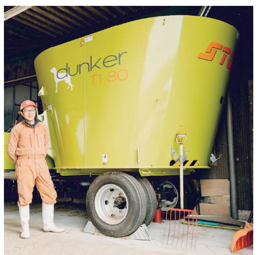
▲飼料を均一に混ぜ、効率的に給餉することができる最新機械を導入。牛の好き嫌いを防止し、食べる量が1.5倍に増えたことで、搾乳量や繁殖成績の向上を実感していると話します。
